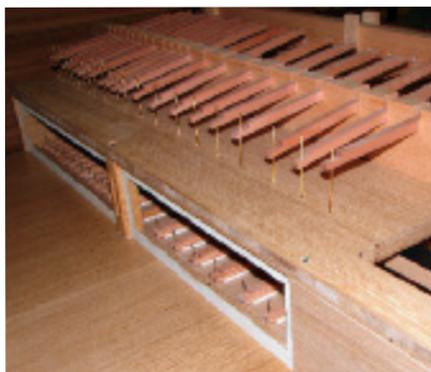
Unter jeder **Windlade** (auf dem Foto liegt sie "bäuchlings") befindet sich die komplizierte Mechanik, die die Ventile im Inneren der Windladen mit den Tasten am Spieltisch verbindet; im Inneren des Windkastens sind die Ventile sichtbar.
